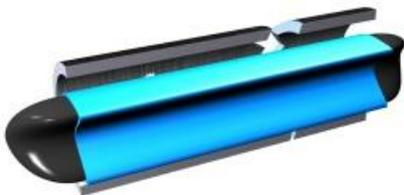
La tecnologia Pull in Place, tradotto letteralmente significa "tirare in posizione", consiste nel rinnovare tubazioni ricostruendo la tubazione dall'interno inserendo una guaina gonfiabile composta di un feltro impregnato da resine epossidiche partendo da un diametro minimo di diametro minimo di 1" 1/2.
